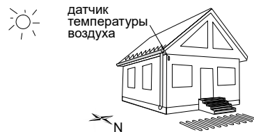
Рисунок 1. Монтаж датчика температуры воздуха
