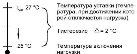
Температура уставки (температура, при достижении которой отключается нагрузка)
